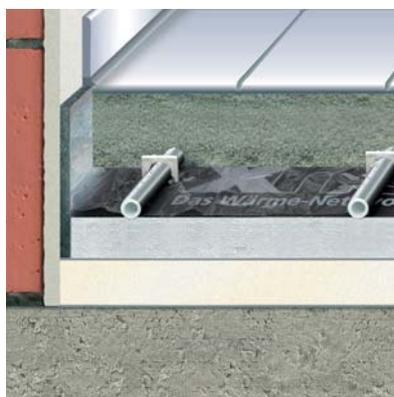
При наличии дополнительной звукоизоляции боковая изоляционная полоса накладывается на нее встык, а затем выкладываются прошивные плиты системы xnet NM 30-2.
