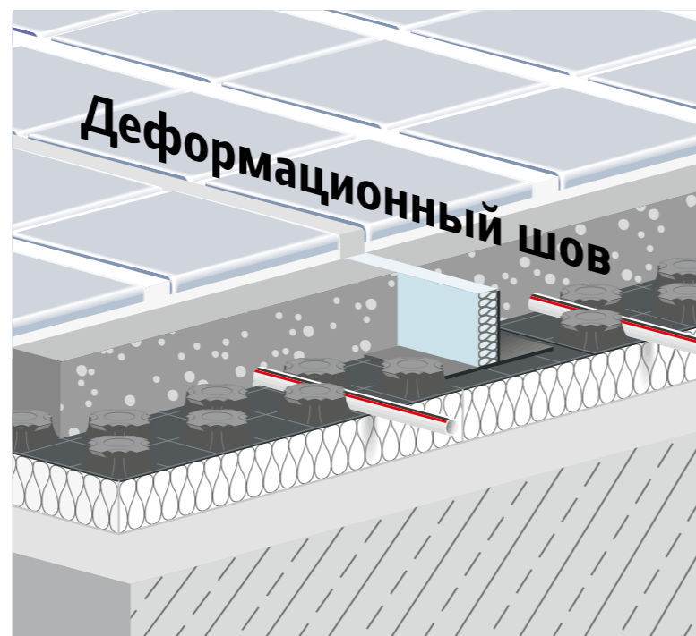
Конструктивное оформление деформационного шва (пример: Uropog Tecto)
