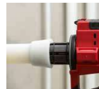
2 Выполните расширение торца трубы с установленным кольцом Q&E необходимого количества раз. Чтобы обеспечить равномерное расширение, расширительная головка выполняет поворот (вращение) после каждого цикла расширения, благодаря встроенной функции автовращения (только инструменты M12 и M18).
