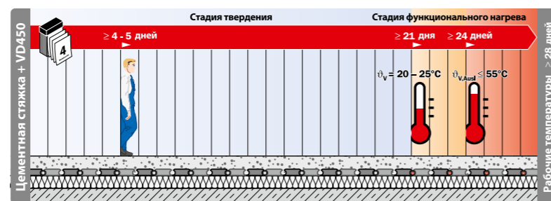
Минимальные промежутки времени после укладки стяжки с цементной добавкой VD 450
