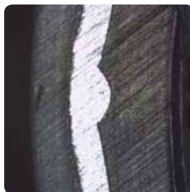
Шов алюминия, сваренного встык
