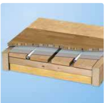
Теплый пол сухой конструкции с пластинами распределения тепла
