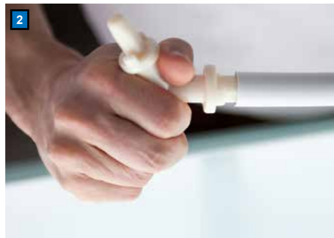
Калибровка Откалибруйте конец трубы
