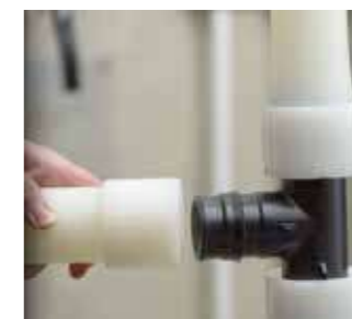
3 Быстро вставьте расширенный конец трубы в фитинг до упора (между торцом кольца и упором фитинга не должно быть зазора). Удерживайте в таком положении в течение нескольких секунд, пока труба не сожмётся вокруг штуцера фитинга. Готово!
