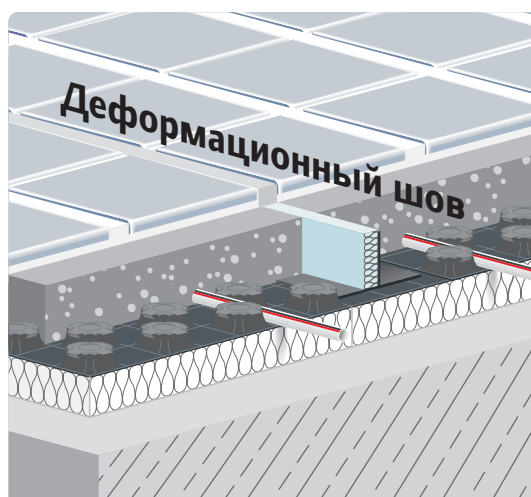
Конструктивное оформление деформационного шва (пример: Upronor Tecto)
