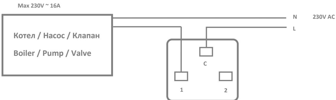
Подключение к нормально закрытому прибору под напряжением - Voltage connection (Normal Closed)
