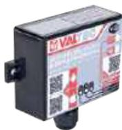
Устройство сбора и передачи данных (УСПД) предназначено для получения информации о расходе ресурсов от приборов учета с импульсным выходом (вода-, тепло-, газовые счетчики), сигналов от датчиков с выходом типа «сухой контакт» (датчик протечки, температуры, давления и т.п.), приводов трубопроводной арматуры, передачи полученных данных по радиоканалу на сервер для дальнейшей обработки и использования.
