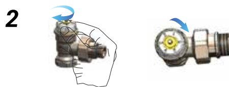
2 Ruotare la manopola numerata finché il numero corrispondente al Kv desiderato (vedi tabella sotto riportata), è allineato all'incisione di riferimento presente sul corpo valvola. Rotate the numbered knob until the number corresponding to the required Kv value (see table below) is aligned with the reference notch on the valve body.
