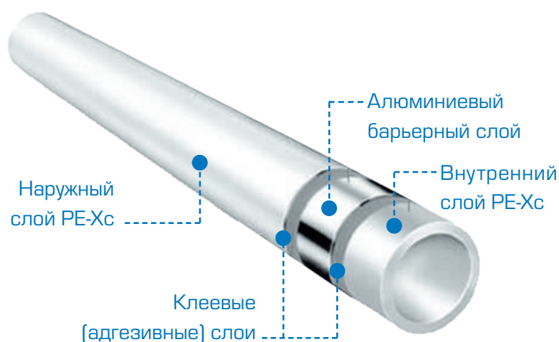
Рис. 2. Пятислойная труба РЕ-Хс/Аl/РЕ-Хс
