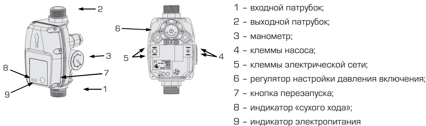
Рис. 38. Элементы устройства управления насосом
