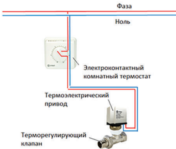
Рис. 3. Схема электрических соединений сети управления
