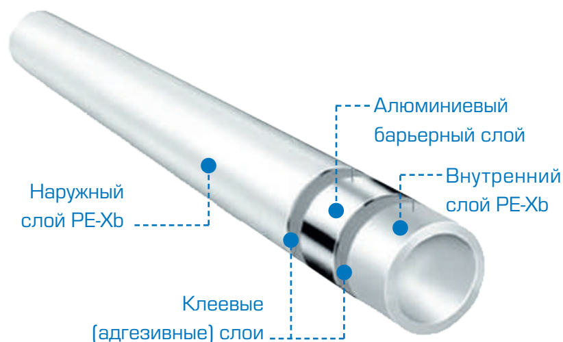
Рис. 5. Пятислойная металлополимерная труба РЕ-Хб/Al/PE-Xb
