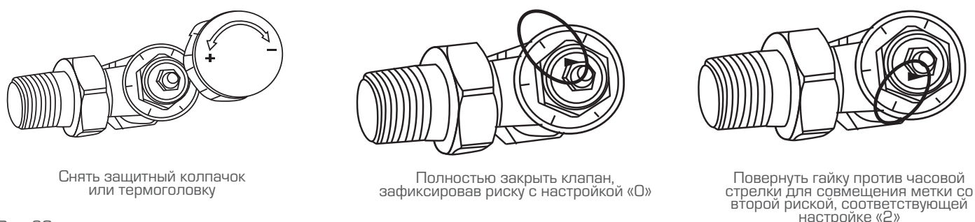
Рис. 20. Пример преднастройки клапана терморегулятора
