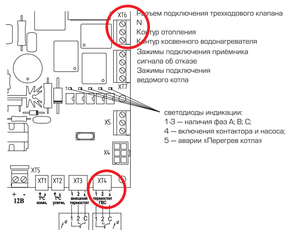
Рис. 13. Схема подключения датчика температуры бойлера
