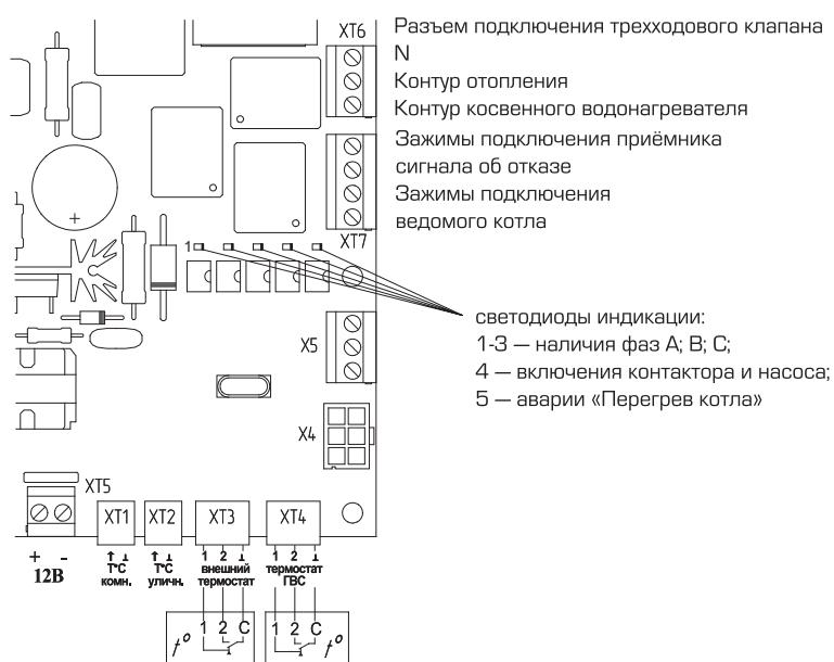
Рис. 5. Расположение разъемов на плате контроллера
