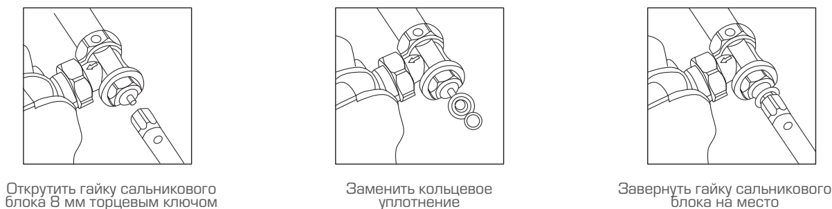
Рис. 21. Замена кольцевого уплотнения штока клапана терморегулятора
