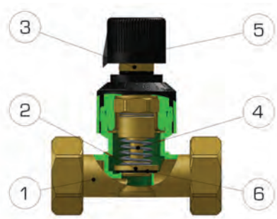
Рис. 11. Устройство перепускного байпасного клапана
