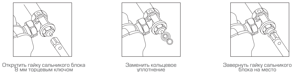
Рис. 21. Замена кольцевого уплотнения штока клапана терморегулятора
