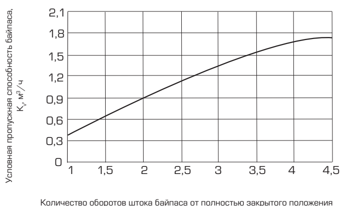
Рис. 44. Диаграмма пропускной способности байпаса универсального узла нижнего подключения в зависимости от количества оборотов его штока
