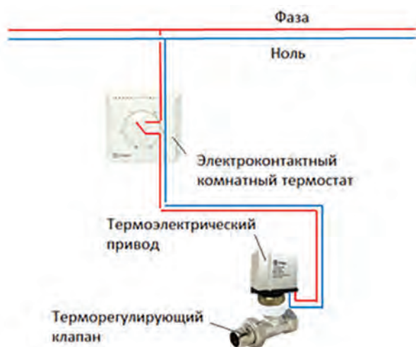
Рис. 3. Схема электрических соединений сети управления
