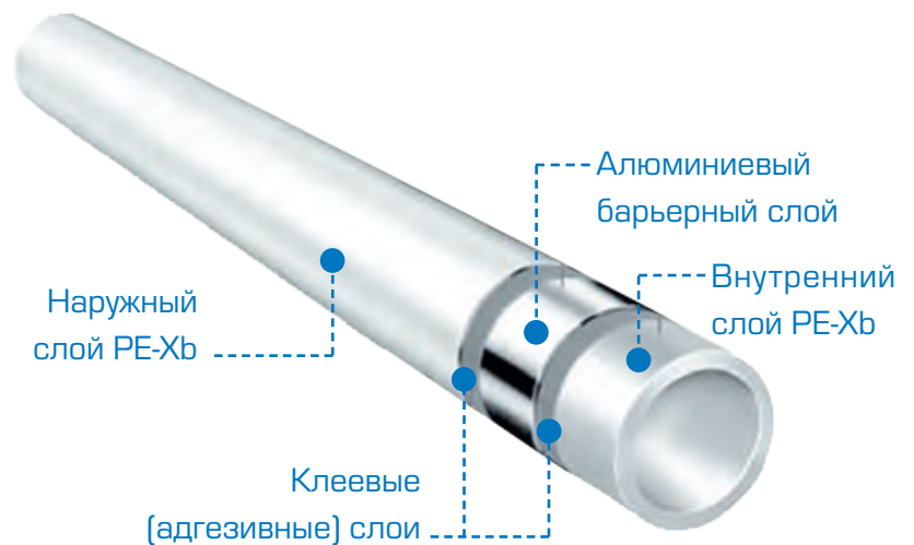
Рис. 4. Пятислойная металлополимерная труба PE-Xb/Al/PE-Xb
