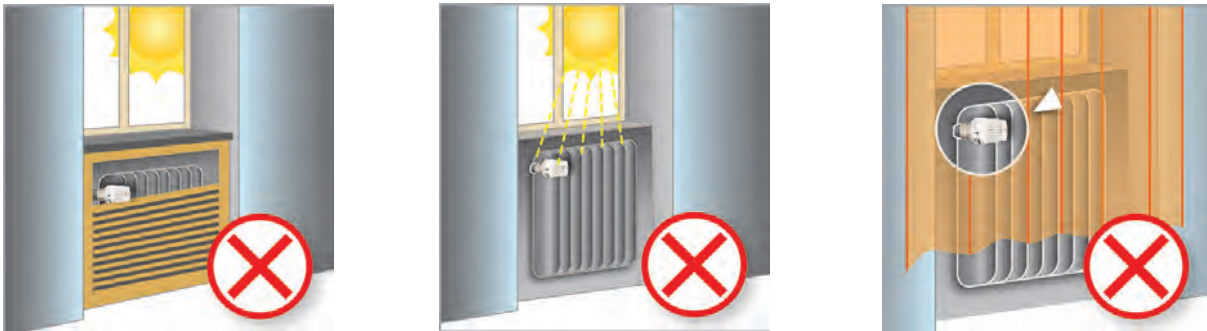
Рис. 8. Требования по размещению автоматического терморегулятора
