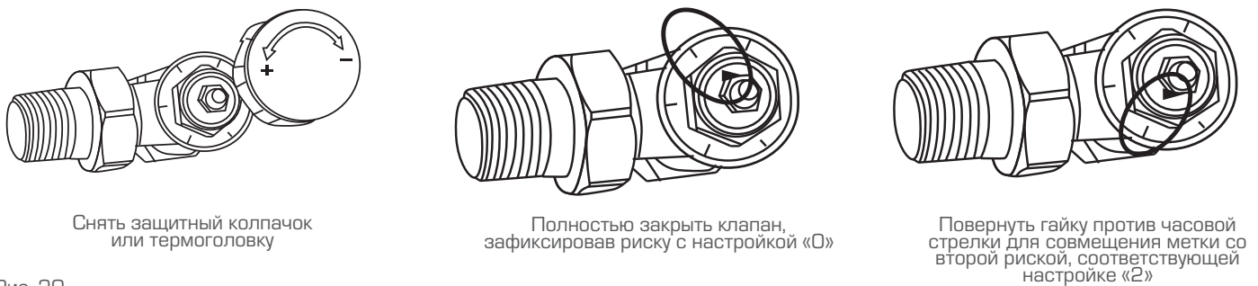
Рис. 20. Пример преднастройки клапана терморегулятора
