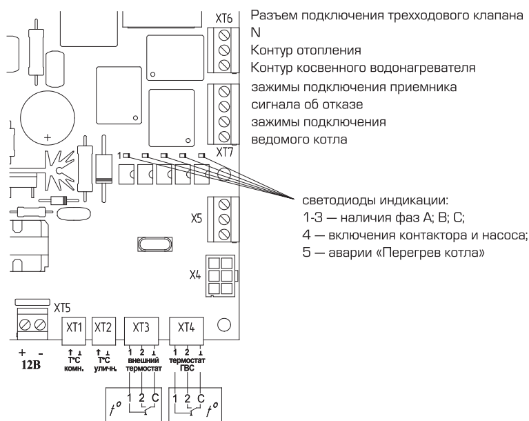
Рис. 5. Расположение разъемов на плате контроллера
