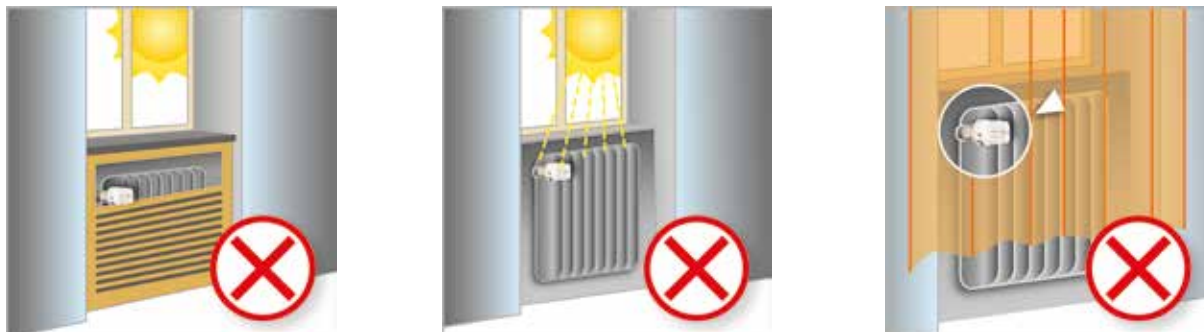
Рис. 7.10. Требования по размещению автоматического терморегулятора
