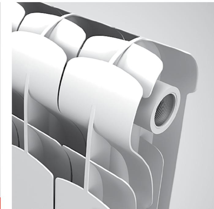
Дополнительное крыло в верхней части секции создает обратно направленный поток воздуха. Обратная конвекция способствует эффективному отсечению холодного воздуха, поступающего из окна, улучшению распределения воздуха по помещению и «выравниванию» амплитуды (перепада) температуры воздуха в разных по высоте слоях.
