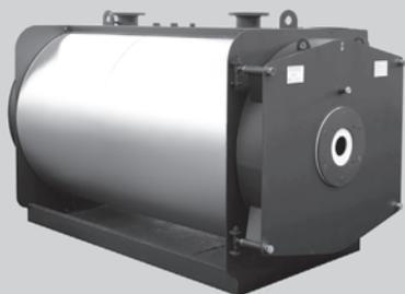
Напольные стальные котлы мощностью от 1,4 до 3,5 МВт для отопления и приготовления горячей воды в дополнительном накопительном бойлере. Возможность работы на магистральном и сжиженном газе, дизельном топливе и мазуте (вид используемого топлива зависит от типа установленной вентиляторной горелки).
