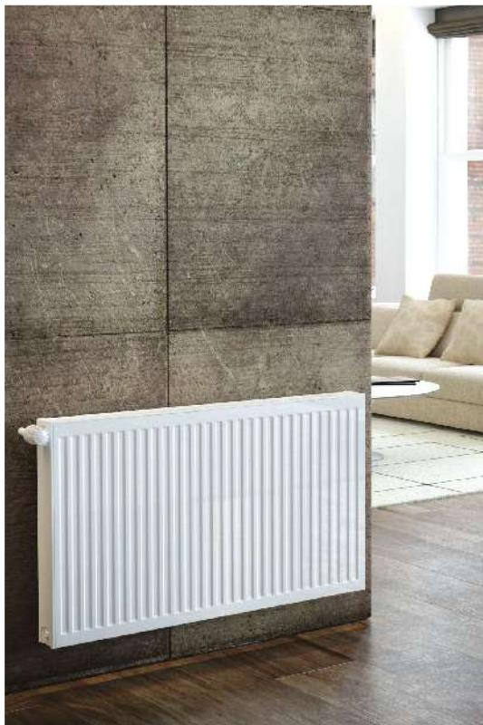
Стальной панельный радиатор Heaton Smart Compact (С) — стальной панельный отопительный прибор, состоящий из отопительных панелей и конвективных листов, двух боковых панелей и декоративной решетки. Исполнение Compact позволяет осуществлять левое или правое боковое подключение к разводке отопительной системы.
