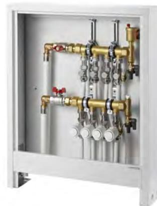
Гребенка сборная из отдельных элементов: концевой элемент, проходной элемент (от 2 до 4 отводов), воздухопускная пробка, шаровый кран, термостатический вентиль „AZ“, вентиль на обратную подводку „Combi 2“, автоматический воздухоотводчик.
