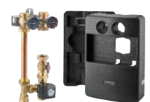
„Regumat M3-180 plus“ Ду 32 с шаровым краном перед насосом с трехходовым смесителем и сервомотором 230 В
