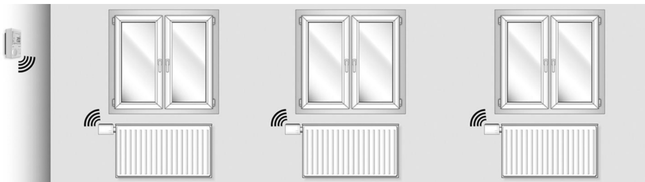
Взаимодействие термостата „R-Tronic“ с приводами „Актор МН CON В“
