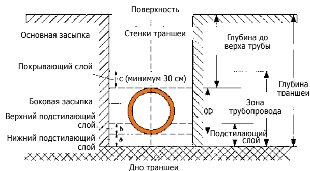
Рис. 3 Устройство траншеи
