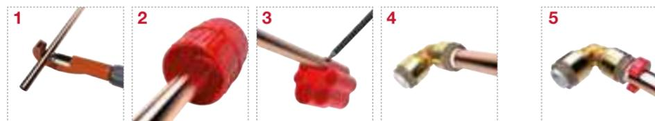
1. Отрежьте трубу роторным резаком.
