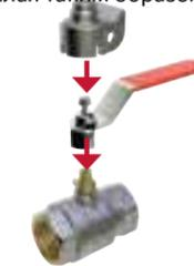
3. Установить и закрыть на замок блок на вентиле. Как в открытом положении, так и в закрытом.
