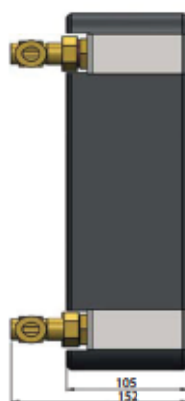
Габаритные и монтажные размеры теплообменника IC8Tx24 (30кВт)
