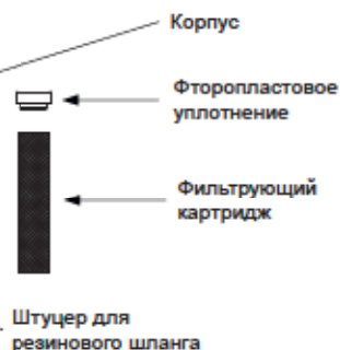
Схема обслуживания фильтра RBM
