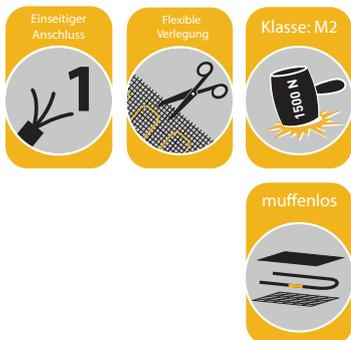
HEM-SYSTEM® Competent Warm® Heizmatten mit einseitigem Anschluss und nahtlosem Muffenübergang. Für Fußbodenspeicher-/Fußbodendirektheizung nur in trockenen, feuchten und nassen Räumen sowie unter Putz und in Estrich verlegen.
