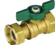
Кран шаровой с внутренней резьбой, с отводом с накидной гайкой для счётчиков, хромированный, с низким содержанием свинца, для питьевой воды.
