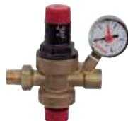
Автоматическая наполняющая группа для автономных систем отопления/охлаждения. Возможность предварительной установки давления жидкости в системе. Съемный картридж и фильтр для легкой чистки и технического обслуживания. С функциями против накипи и регулировки давления через компенсирующее седло. Подсоединения: подача 1/2" HP с отводом с накидной гайкой, выход 1/2" BP, манометр 1/4" BP.
