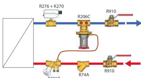
Клапан регулирования дифференциального давления устанавливается на обратный трубопровод. Стрелка на корпусе клапана показывает направление потока. Положение установки клапана может быть любым. Рекомендуется устанавливать запорные клапаны до и после регулятора дифференциального давления. Для очистки рабочей среды, необходима установка гравийного фильтра R74A.
