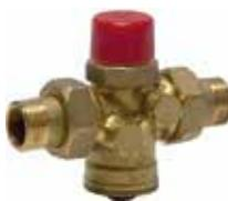
Клапан балансировочный комбинированный компактный - автоматический регулятор расхода с возможностью установки управляющего сервопривода. Имеет гнезда для подключения измерительных штуцеров. Поставляется с двумя отводами с накидной гайкой.
