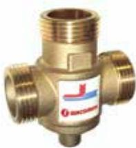
Антиконденсный термостатический смесительный клапан предназначен для регулирования и поддержания заданной температуры теплоносителя в обратном контуре твердотопливного котла или котла с наддувной горелкой. Использование термостатического смесительного клапана предотвращает образование конденсата в теплообменнике и дымоходе котла. Клапан, таким образом, влияет на эффективность работы котла и защищает его от повреждений.
