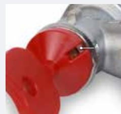
2. Повернуть шток винта специальным нумерованным ключом. Установить требуемый номер преднастройки, указанный на регулировочном ключе, напротив метки А на корпусе клапана.
