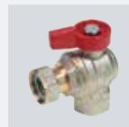
Угловой полнопроходной шаровой кран с внутренней резьбой и накидной гайкой с плоской прокладкой, для гидравлических систем, латунный никелированный с алюминиевой фланковой рукояткой.
