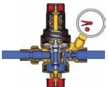
После достижения заданного (калибровочного) давления затвор клапана (A) автоматически полностью герметично закрывается, перекрывая подачу воды. Интегрированный обратный клапан (B) препятствует возврату потока из контура циркуляции.
