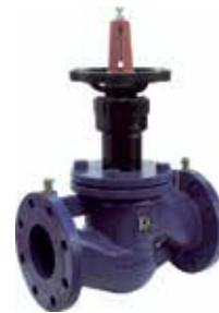
Статический балансировочный клапан с измерителем расхода с калиброванным отверстием (работающий по принципу Вентури) с фиксированным значением коэффициента пропускной способности Kv. С возможностью установки механической памяти для выбранного значения настройки. Версии с ниппелями для подключения измерительного прибора и без ниппелей с отверстиями для возможности установки штуцеров. Максимальная рабочая температура 110 °C. Максимальное рабочее давление 25 бар.
