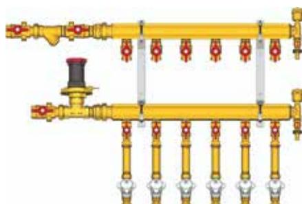
Узел коллекторный отопления этажный, подключение к системе с регулятором перепада давления, подключение к потребителям тип В3: с шаровым краном, отводом с накидной гайкой, балансировочным клапаном - регулятором перепада давлений и проставкой на место монтажа теплосчетчика.
