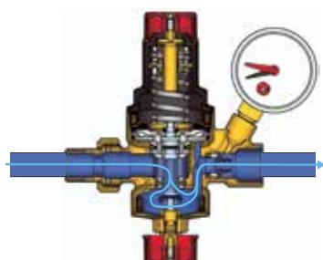
Вода поступает в подпитываемый циркуляционный контур через клапан R150M до тех пор пока давление в контуре не достигнет заданного (калибровочного).
