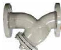
Косой сетчатый фильтр, с фланцевым соединением, корпус из чугуна, фильтрующий элемент из нержавеющей стали.
