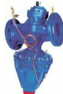
Автоматический регулятор перепада давления, для поддержания дифференциального давления вне зависимости от изменения значения расхода. Двойной диапазон регулирования 5-30 кПа и 25-60 кПа, переключение диапазона поворотным кольцом на клапане. Капиллярная трубка длиной 1000 мм входит в комплект.
