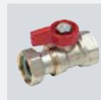
Прямой стандартноХроходной шаровой кран с внутренней резьбой и накидной гайкой с плоской прокладкой, для гидравлических систем, латунный никелированный с алюминиевой фланковой рукояткой.
