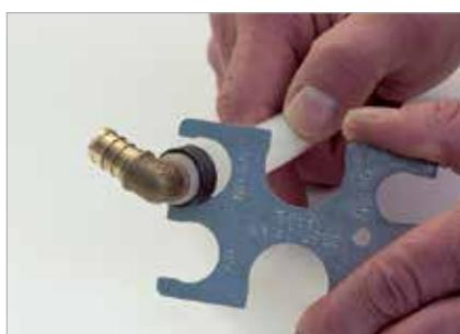
Не проверяйте само соединение, нужно проверять обжатое кольцо.
