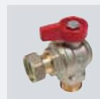
Угловой полнопроходной шаровой кран с наружной резьбой и накидной гайкой с плоской прокладкой, для гидравлических систем, латунный никелированный с алюминиевой фланковой рукояткой.
