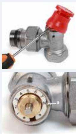
1. Снять красный колпачок с помощью отвертки. Шток (деталь В) находится в положение N = Все открыто.
