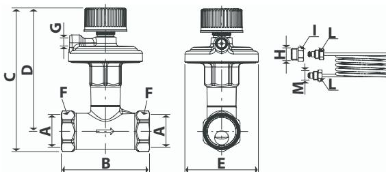
Балансировочный клапан R206C-1 - это регулятор перепада давления для поддержания постоянного перепада давления в любом гидравлическом контуре при любом расходе. Диапазон регулирования номинального перепада давления от 5 до 30 кПа. Клапан поставляется с капиллярной трубкой длиной 1м, для подсоединения к штуцеру или регулятору расхода (например, R206B) на подающем трубопроводе.
