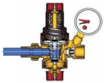
При падении давления в циркуляционном контуре ниже заданного клапан R150M автоматически поднимет давление до необходимого уровня.
