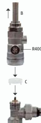
Для клапанов серии PTG имеется возможность демонтажа запорного элемента без сброса давления и остановки системы отопления, с помощью специального ключа R400.
