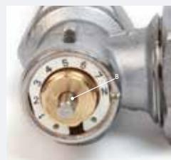
3. При снятии ключа шток (деталь В) останется в требуемом положении преднастройки, определяемой по номеру на кольце клапана. Положения настройки: 1, 2, 3, 4, 5, 6, 7, N = Все открыто. Кроме обозначенных настроек, имеющих паспортные тарированные значения, можно установить и промежуточные положения настроек.
