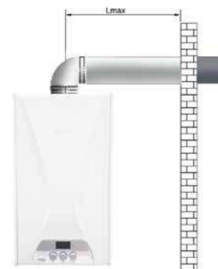
Горизонтальная система дымоудаления (Lmax с одним коленом: 4 м, 60/100) (Lmax с одним коленом: 6 м, 80/125)
