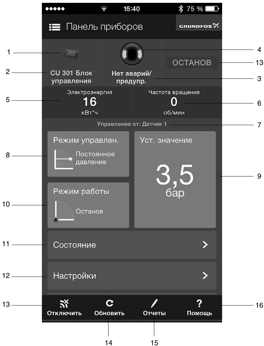
Рис. 25. Устройство беспроводного управления Grundfos Go
