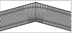
Безразъемный плавный угловой переход с роликовой решеткой
