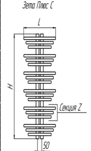
Пример обозначения: «Зета Плюс - Z - L», где Z- количество секций, L – ширина прибора
