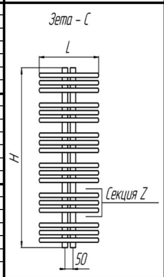
Пример обозначения: «Зета - Z - L», где Z- количество секций, L – ширина прибора
