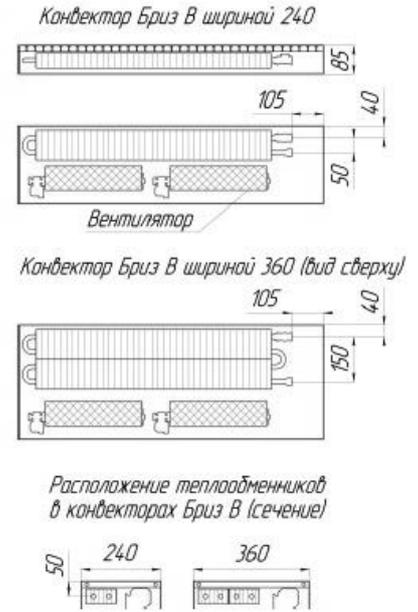
Базовый вентилятор: напряжение питания - 220В, 50Гц; мощность – 11 Вт
