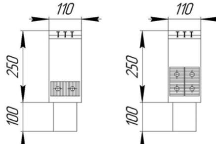
*Расположение теплообменников в конвекторах Элегант высотой 400 (сечение)*
