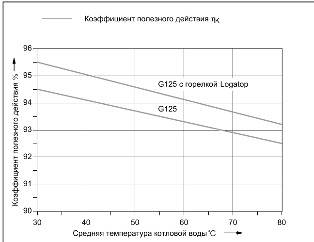
Диаграмма: Нормативный коэффициент полезного действия в зависимости от средней температуры котловой воды
