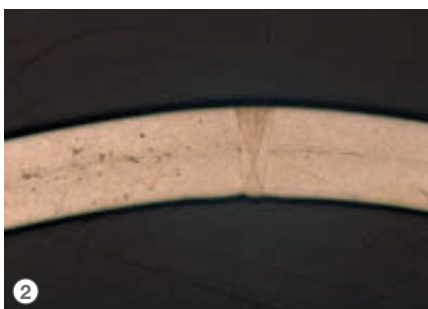
2 Узкий лазерный сварной шов Viega.
