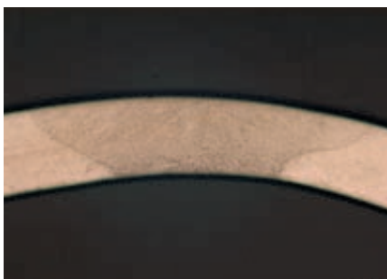
Обычный широкий шов, выполненный вольфрамовым электродом в инертном газе.
