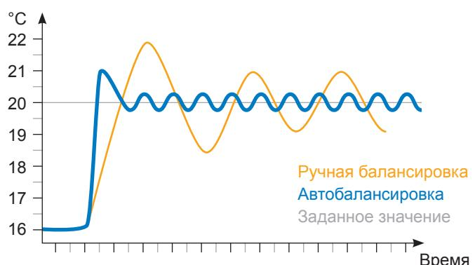
В отличие от ручной балансировки, при которой учитывается состояние системы лишь в определенный момент времени, при автобалансировке учитываются все изменения условий в системе или во всем здании; при этом не требуются дополнительные расчеты, которые необходимы для ручной балансировки. Это позволяет экономить энергию и с высокой точностью поддерживать в помещении заданную температуру для создания оптимально комфортных условий.
