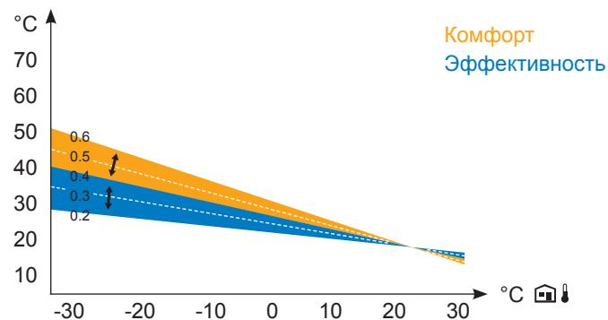
**Динамическая кривая отопления при использовании Smatrix**
