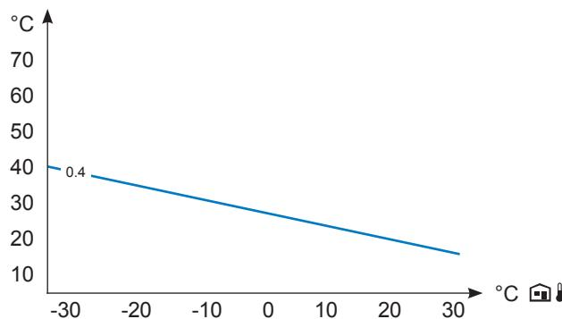
**Статический график отопления без использования Smatrix**
