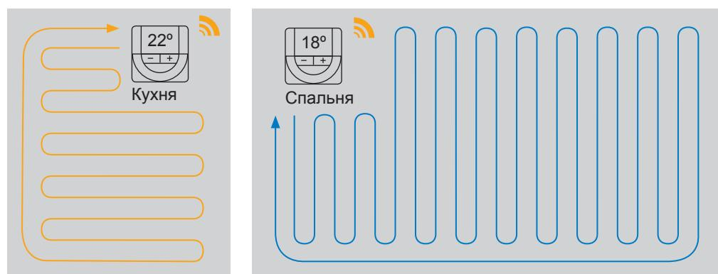
**Автобалансировка отопительных контуров** означает, что открывание и закрывание коротких и длинных петель происходит в строго определенное время и при этом расходуется точно рассчитанное количество энергии.
