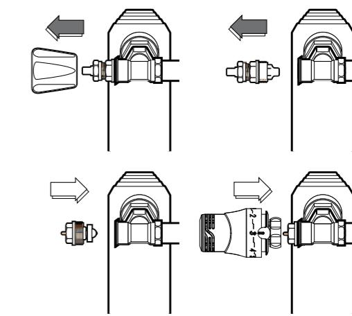
ПРЕОБРАЗОВАНИЕ КЛАПАНА СОМАР С РУЧНЫМ УПРАВЛЕНИЕМ В ТЕРМОСТАТИЧЕСКИЙ КЛАПАН
