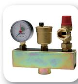
**Группы безопасности котла KSG 30** предназначены для защиты автономных отопительных систем. Представляют собой комбинацию предохранительного клапана, воздухоотводчика и манометра, размещённых на специально расширенной консоли (присоединение – 1”).
