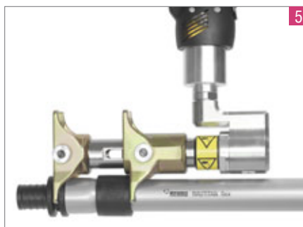
Установить запрессовочные тиски
