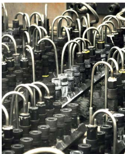
Испытания на износостойкость при высоком давлении и температуре
