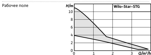
**Тип** Циркуляционный насос с мокрым ротором с резьбовым соединением
