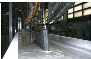
На радиаторы наносится двухслойное лакокрасочное покрытие, (данная технология используется при производстве 80 % радиаторов отопления Европы). Покраска осуществляется компонентами фирмы Frei Lacke (Германия).
