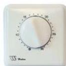
**Комнатный термостат BELUX** - температурный гистерезис переключения - 0,6 К. Диапазон регулирования от 5° до 30°С. Широкий выбор типов с различными функциями и комплектацией, возможность программирования различных температурных режимов (ECOLUX, XELUX). Выпускаются также накладные термостаты (на трубу до 2"), котловые (погружные), с капиллярной трубкой, температурные ограничители (аварийные отключатели) и т. д.
