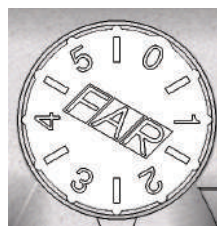
Рис. 25. Шкала открытия клапана
