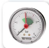
Модели **MNA** и **MHR** рассчитаны на диапазон измерения от 0 до 4 бар и оснащены зелёными флажками, красной установочной стрелкой и красной контрольной риской на отметке 2,5 бар (согласно DIN 4751 для автономных отопительных систем).
