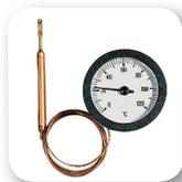
**Термометр дистанционный ТС 50/100** предназначен для замера температуры теплоносителя в котлах. Приспособлен для монтажа в приборную панель, где закрепляется защёлками. Состоит из медной капиллярной трубки длиной 1000 мм и медного датчика 6,5x30 мм. Диаметр рамки - 57,5 мм. Диапазон измерений - от 0°C до 120°C. Арт. 03.00.050
