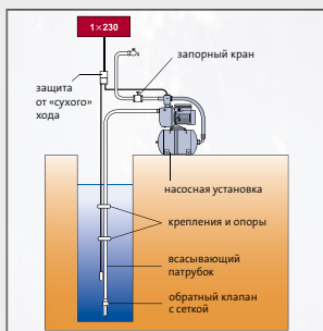
Пример системы водоснабжения на базе установки JPB
