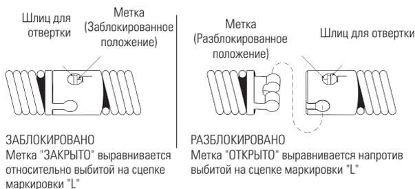
Сцепка отличается наличием штифта и пружины из нержавеющей стали; устраняет потребность в пробойниках, стойках или расширяющихся штифтах
