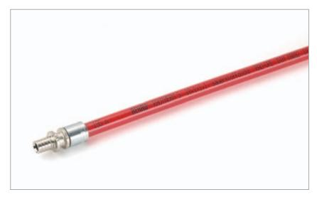
Если Вы заинтересованы в уменьшении толщины конструкции греющего пола или стен, программа RAUTHERM S предоставит Вам такую возможность. Взяв трубу RAUTHERM S 10 х 1,1, используя фиксирующую шину под эти трубы с толщиной основания 4 мм и высотой 13 мм, входящую в программу. Таким образом высота конструкции, которую необходимо заливать в стяжку составляет всего 13 мм! При этом шаг укладки труб может быть кратен 25 мм!
