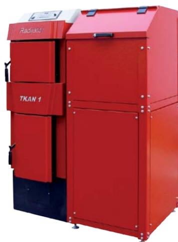
Серия ТКАН - предлагается как комбинированный котел на топливу, который прекрасно работает и на пелетах, и на поленьях/брикетах (колосники в комплекте). Двухшнековая система подачи пелет с противопожарным клапаном\* - является типовой схемой обеспечения противопожарной безопасности.
