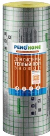
РеноНоме Экофол – теплоизоляционный рулонный материал из вспененного полиэтилена, дублированного металлизированной лавсановой пленкой. Материал подходит для любой системы «теплый пол»: электрической, водяной, инфракрасной и пр. РеноНоме Экофол выпускается с разметкой для правильного монтажа нагревательных элементов системы.
