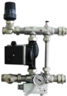
Группы циркуляции FBR позволяют напольное отопление подключать к высокотемпературным радиаторным системам отопления. Предназначены для циркуляции теплоносителя и поддержания постоянной температуры подающей линии в низкотемпературных системах отопления (напр. теплый пол). Термостатической головкой на смесительном клапане устанавливается желаемая температура подачи в пределах от 20°C до 50°C. При этом температура котловой воды должна на 10-15°C превышать желаемую температуру подачи тёплого пола.
