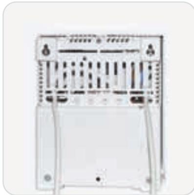
Устройство сопряжения для подключения газового котла к сетям переменного тока без заземления. Мощность нагрузки 200 ВА. Устраняет проблемы с некачественным заземлением — паразитные токи и наводки, напряжение и помехи по «земле» — «грязная земля». Адаптация котла для работы с автономными генераторами. Если автоматика котла постоянно «ходит в ошибку», Teplocom GF — для вас.
