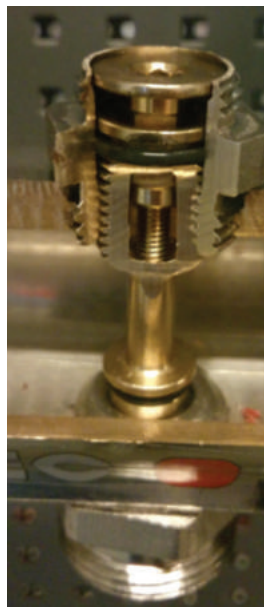
Рис.12 Настрочный клапан открыт до упора в фиксирующий винт
