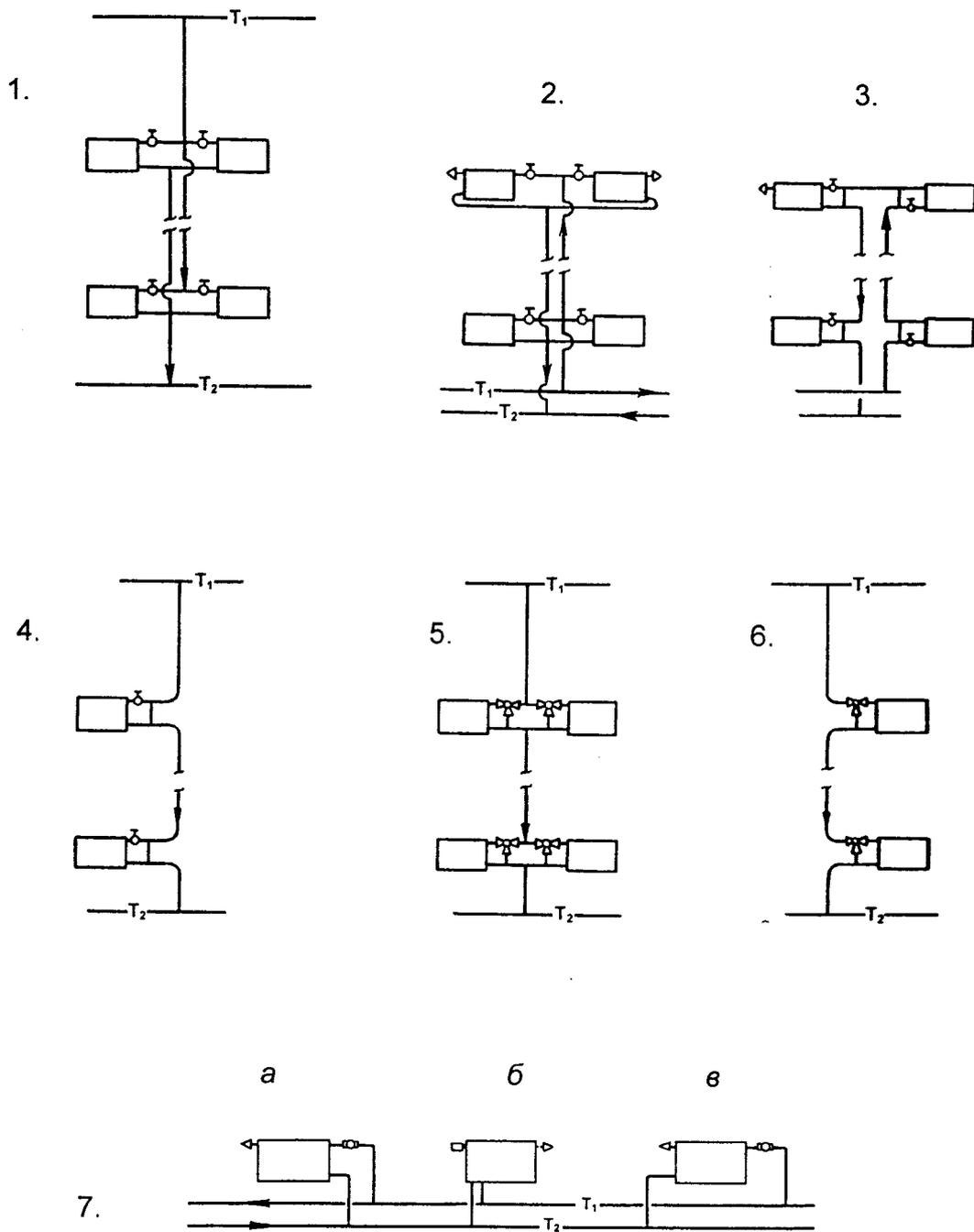
Рис. 2.1. Схемы систем водяного отопления:
