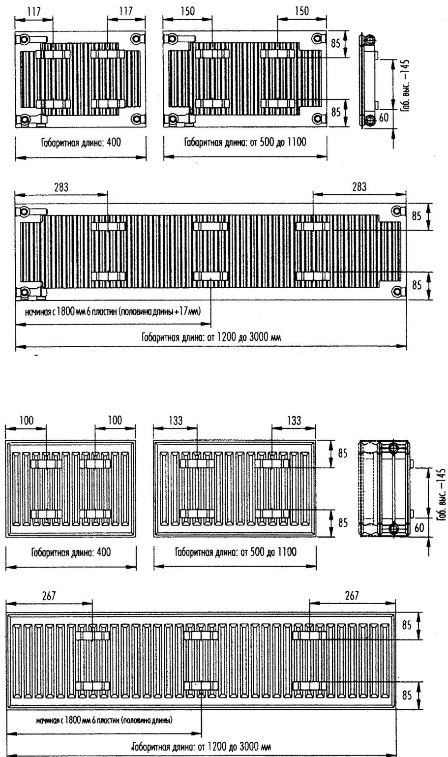
Рис. 6.1. Размещение скоб для радиаторов «Stilrad» различных типов
