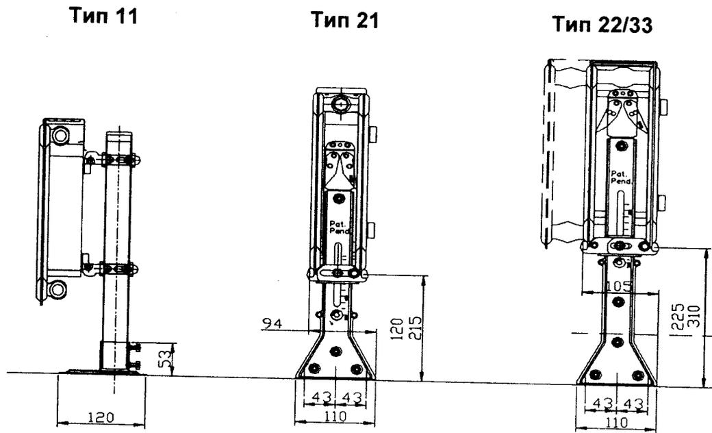
Рис. 6.4. Напольная установка различных типов радиаторов «Stelrad»
