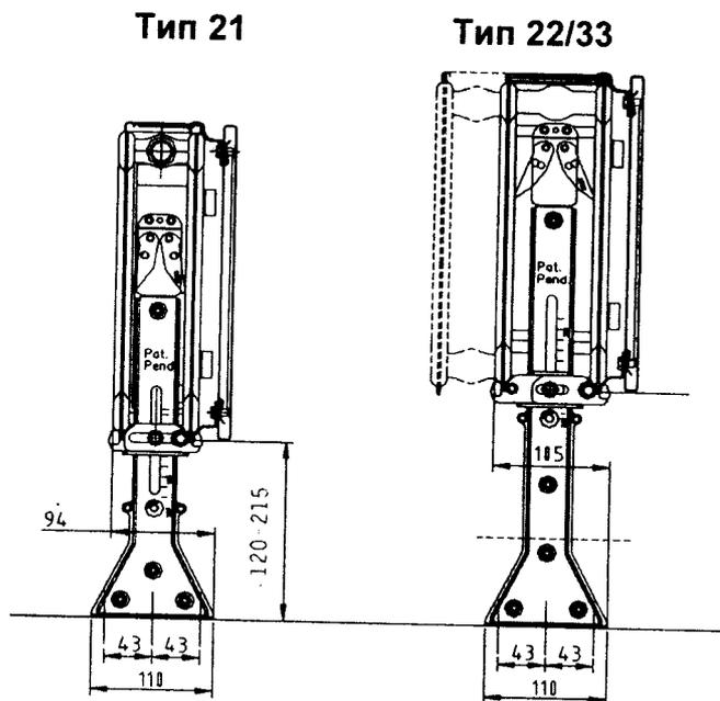
Рис. 6.5. Установка теплозащитных экранов у напольных радиаторов «Stelrad» для защиты от радиационных тепловпотерь
