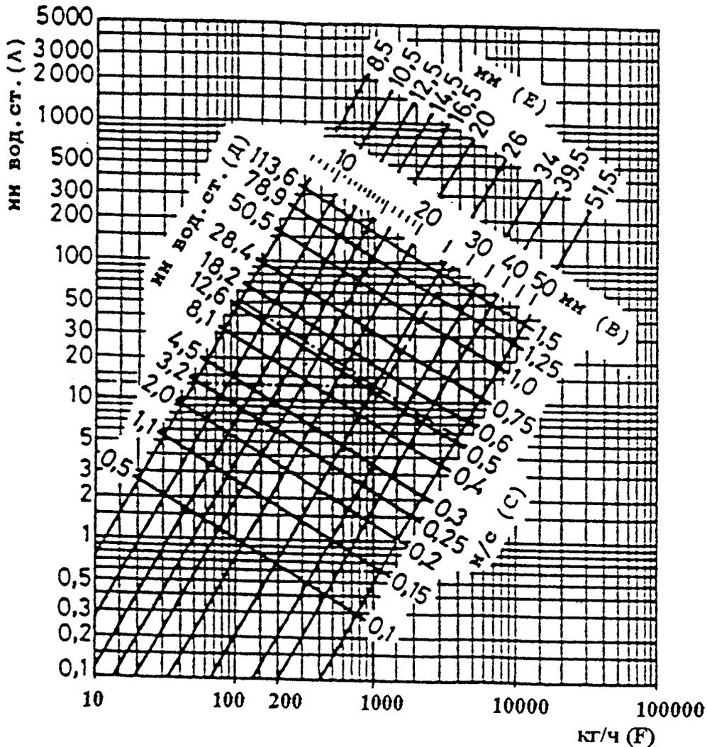
**А** – потери давления на трение в медных трубах длиной 1 м при температуре теплоносителя 40°С, мм вод. ст.;
