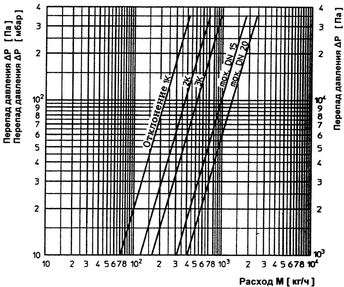
Рис. 2.5. Гидравлические характеристики термостатов серии «М» фирмы «Овентроп»
