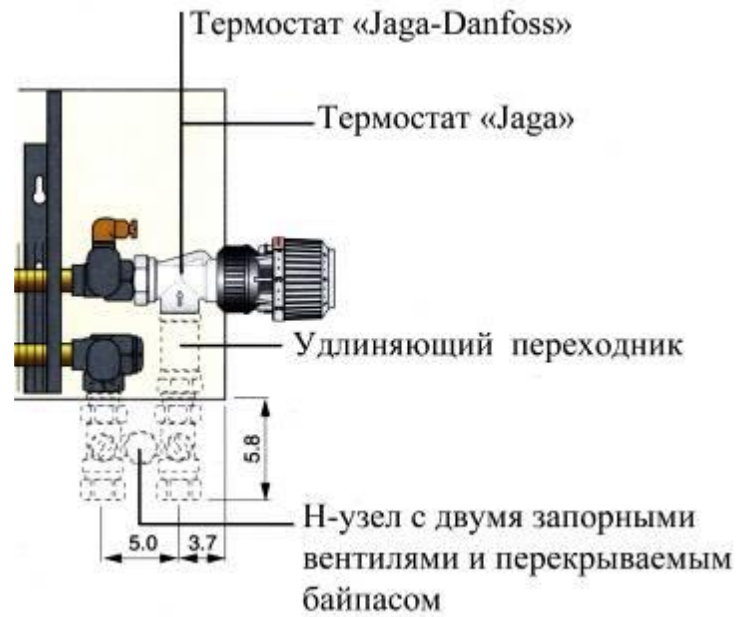
Рис. 3.6. Схема подключения Н-узла (размеры приведены в см)
