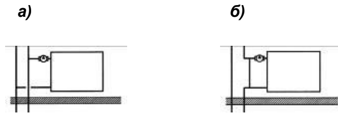
Рис. 2.4. Схемы присоединения приборов в двухтрубных (а)
