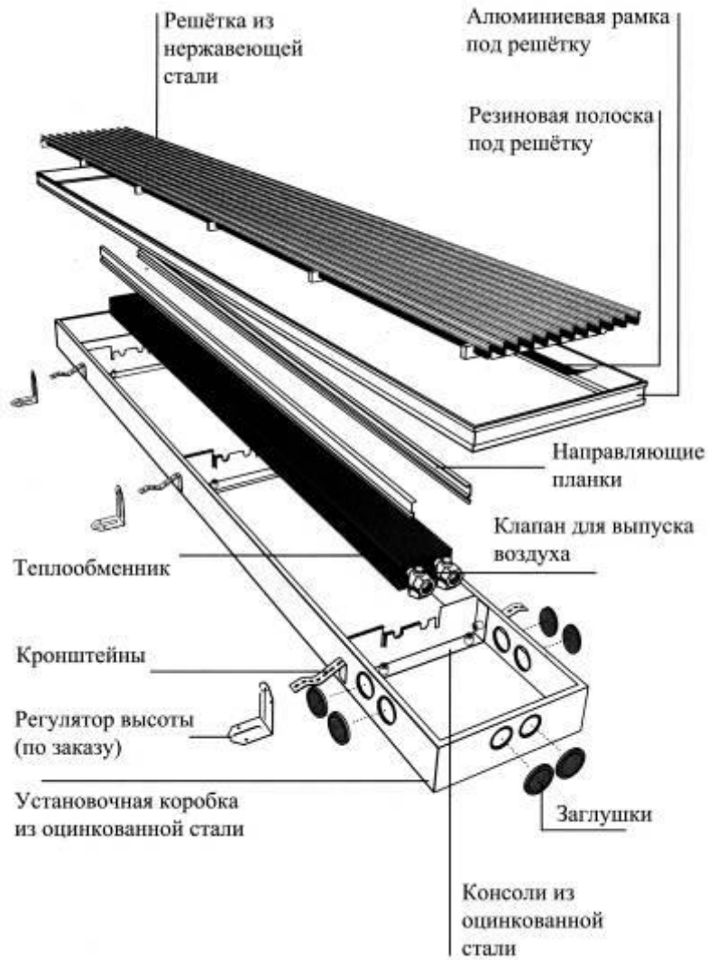
Рис. 5.1. Основные конструктивные элементы встраиваемого в пол отопительного прибора «Mini-Canal»
